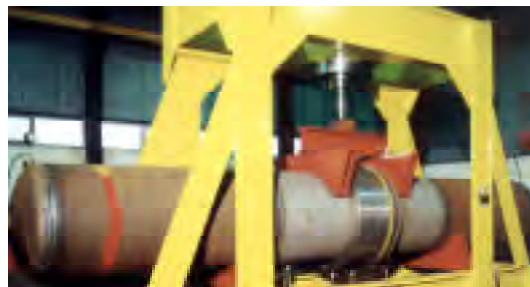
Monolithic insulating for pipeline with high bending stress during combined bending-pressure test Giunto isolante monolitico per tubazione con elevato stress a flessione durante la prova combinata di presso-flessione
